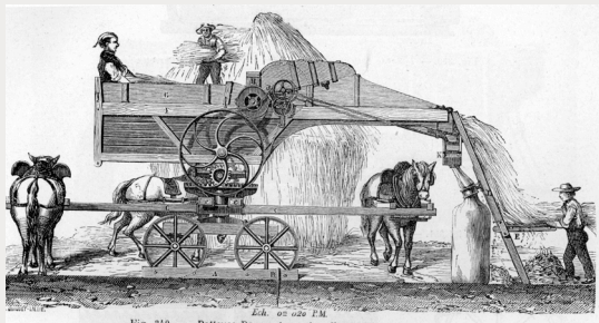
Zeichnung einer Dreschmaschine mit pferdebetriebenen eingebautem Göpel (1881).
